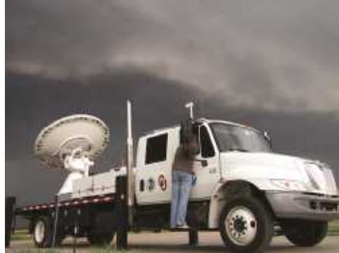
Equipo móvil para la alerta de tornados. EE. UU.
