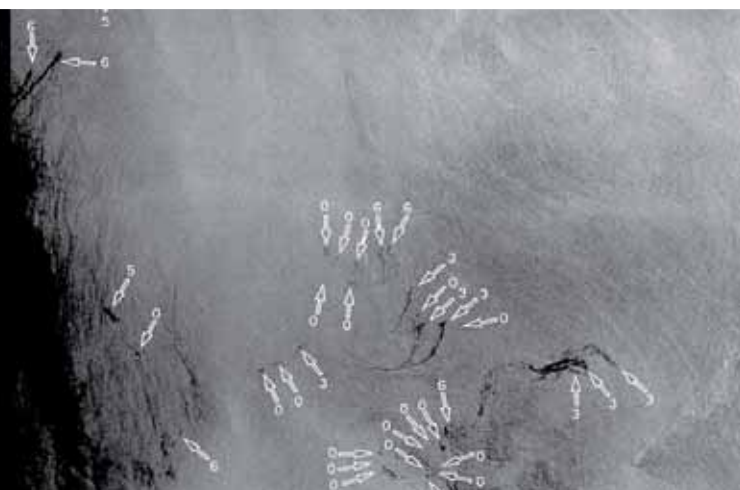
Figura 6. Utilización de imágenes satélite para localizar escapes de petróleo en grandes superficies marinas.
