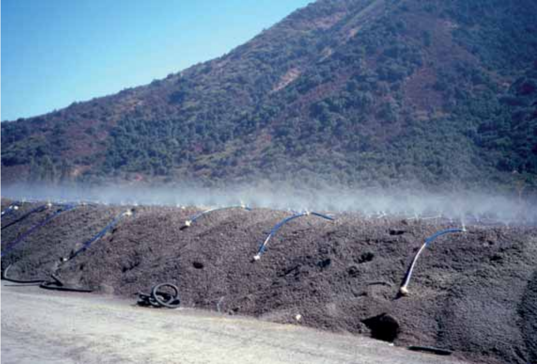
Figura 5. Cianuración en pila en la mina El Solado, Chile.
