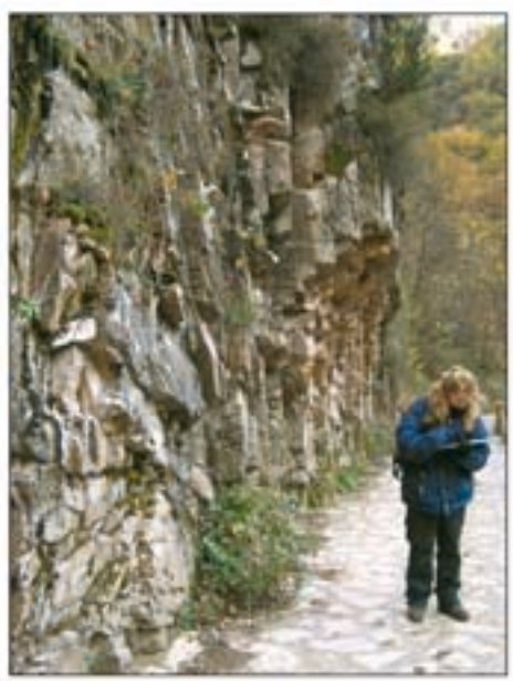
Foto 41. La intersección de diaclasas y estratificación delimita bloques de roca que pueden experimentar procesos de desprendimiento.
